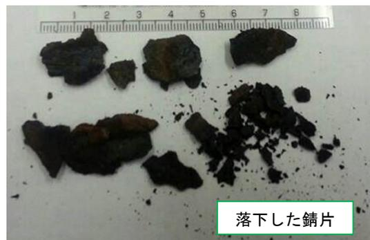
写真2 落下した錆片 (落下の際に破碎)
