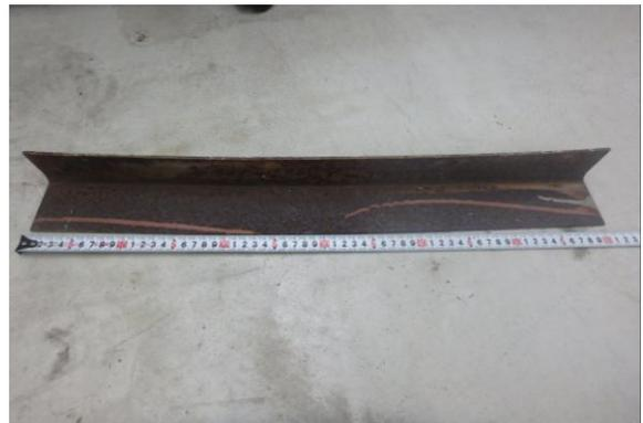
写真 2 落下した鋼材
