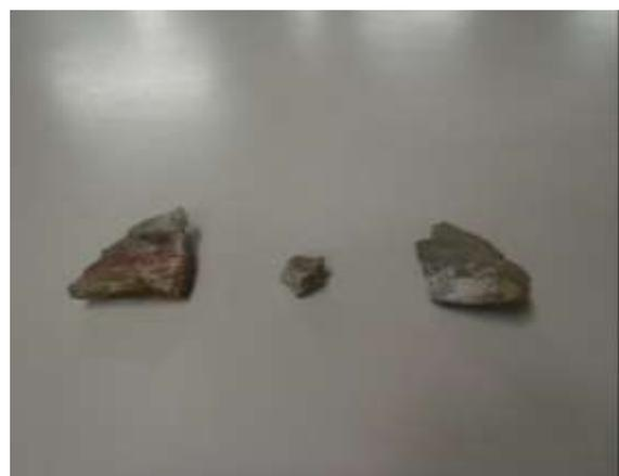
写真 2 落下したコンクリート片
