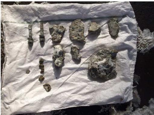
写真3 落下したコンクリート片およびボルト
