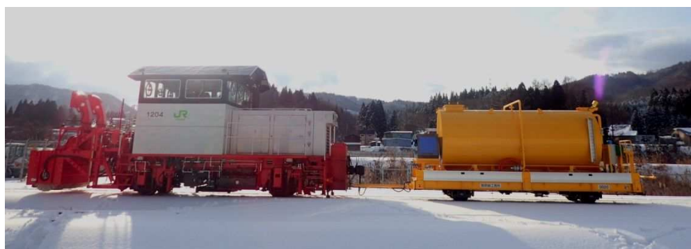
【ブラシ式除雪装置】+モーター+【凍結防止剤散布用タンク】
