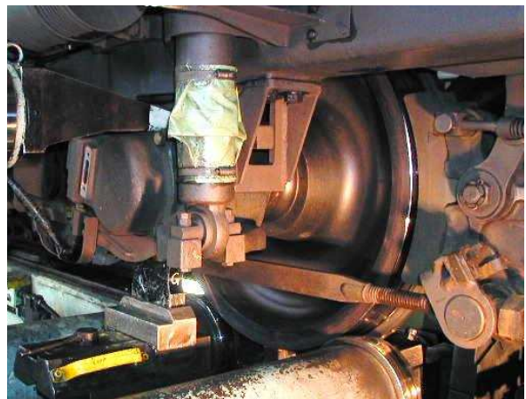
▲車輪を削っている様子(車輪旋盤)
