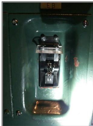
図2 損壊したATSスイッチ
