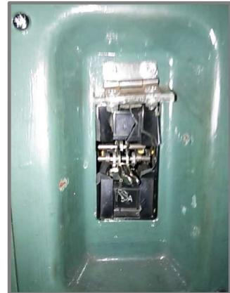
図3 損壊したATSスイッチ
