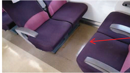
A列第1消音器上部客室内 床敷物熱変色なし
