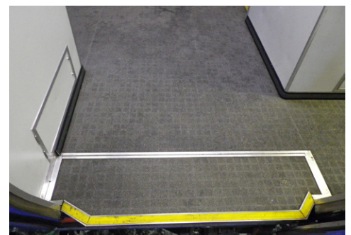
【段差がない車両の一例】
