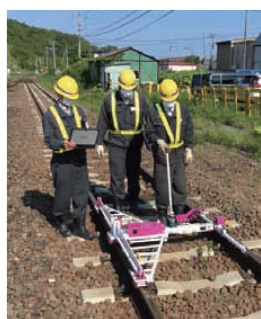
トラックマスターでレールの歪みを測定
