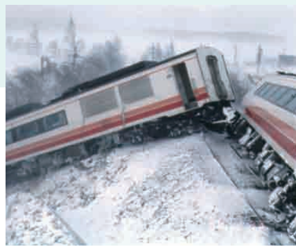
1994年2月、突風による特急おおぞら10号の脱線事故(根室線)。
