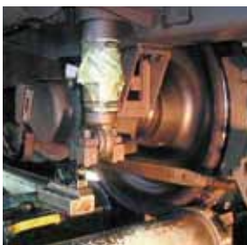
車輪削正を徹底し、昨シーズンの列車運休の原因になった車輪表面の剥離に対応。
