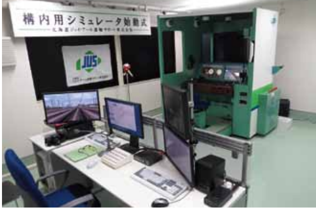
手稲にある札幌運転所に設置した「構内用シミュレータ」。運転士卓と指導卓からなり、指導卓では操作状況の確認と評価を行うことができる。
