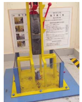
16kgの制輪子を実際に落下させる装置「落下制1号」。
