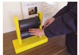
ローラーに手を巻き込まれる装置「傷だらけのローラ」。
