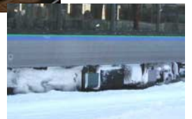
床下機器カバーがないとこの状態。いつ雪や氷塊が落下するかわからない
