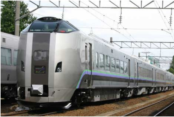
平成19年にデビューした特急スーパーカムイ。ポリカーボネートを使用した客室窓、床下機器カバー、押さえシリンダー式ドアなど、すべての事故防止対策を完備している
