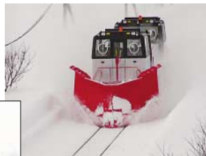
排雪モーターカーは時速50km で雪を脇へ押しやる除雪機 械で除雪を急ぐ時に最適！ 58台中14台が新型
