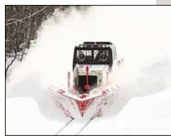
排雪モーターカーは時速50km で雪を脇へ押しやる除雪機 械で除雪を急ぐ時に最適！ 58台中14台が新型
