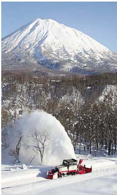
線路上の雪を速く飛ばす「排雪モーターロータリー」。 駅構内の除雪に活用されることが多いが、排雪モーター の機能を併せ持つことから駅間での除雪にも運用。56台 中43台が新型
