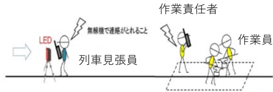
工務関係触車事故防止の保安体制の一例
