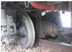
脱線車両（台車付近）
