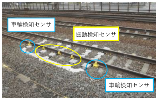
車輪検知センサ・振動検知センサ
