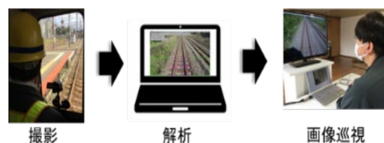
車上撮影画像データを用いた線路総合巡視のイメージ
