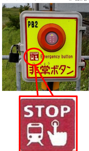
ピクトグラムを表記した踏切非常ボタン(踏切支障報知装置)
