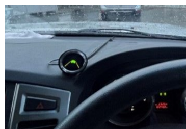
社用車の安全警報装置（衝突防止補助システム）
