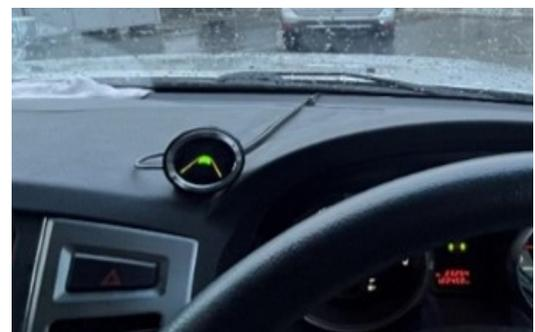
社用車の安全警報装置(衝突防止補助システム)
