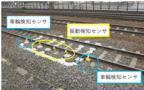
車輪検知センサ・振動検知センサ
