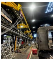
共引き状態の防止を考慮した墜落防止用器具取付け設備
