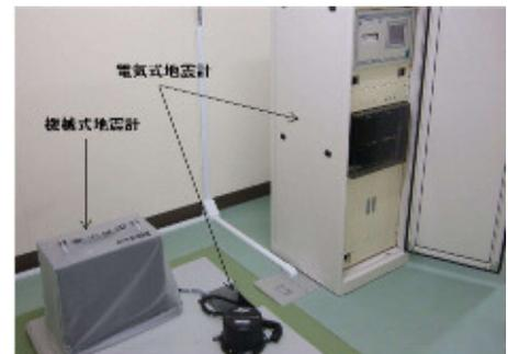
電気式地震計と機械式地震計
