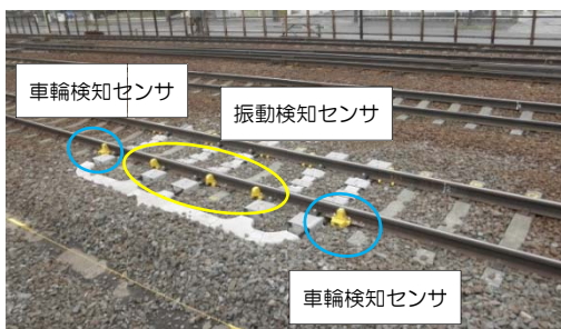
車輪検知センサ・振動検知センサ（苗穂駅構内）
