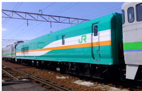
新型の軌道検測車「マヤ 35 形」
