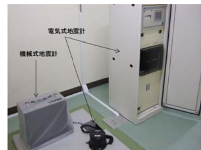
電気式地震計と機械式地震計
