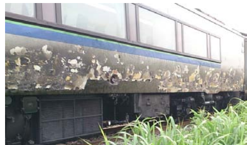
焼損した車体の側面
