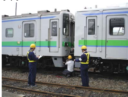
(現地における安全診断) ・車両の分割作業点検状況
