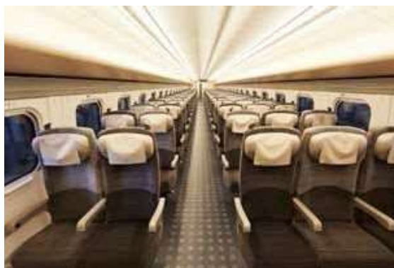
H5系車両の室内LED照明(普通車)
