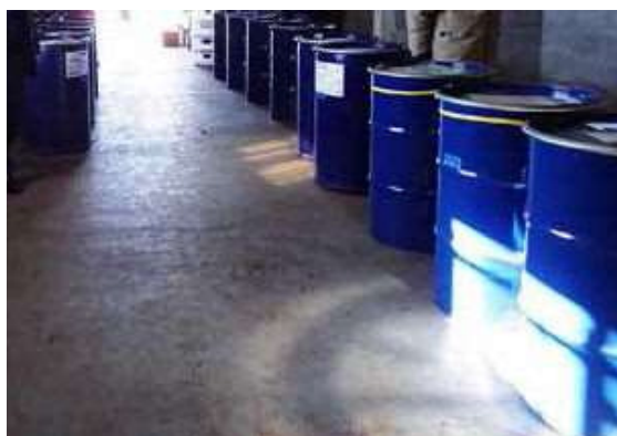
PCB廃棄物の保管状況
