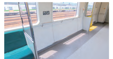
車いすスペースの例（733系4000代）
