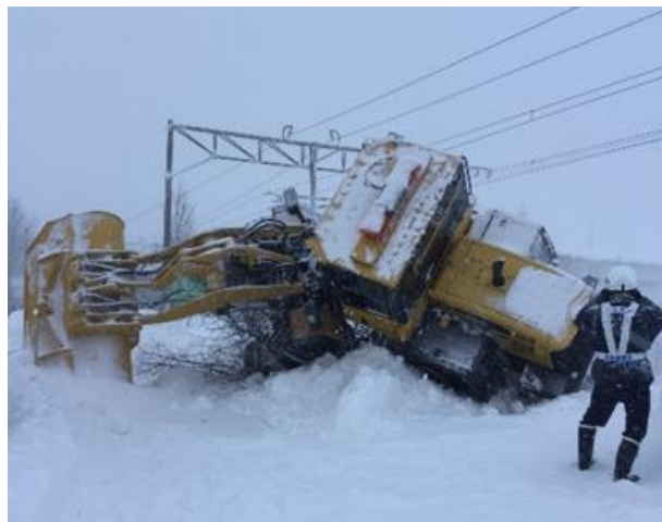
図－3 接触した除雪用ホイールローダー
