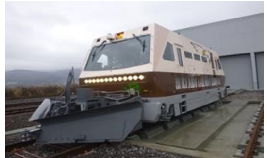
除雪装置を装着した確認車
