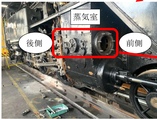
蒸気室外観 (ピストンを抜いた後)
