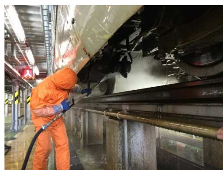
出発前(車両基地)の除去作業
