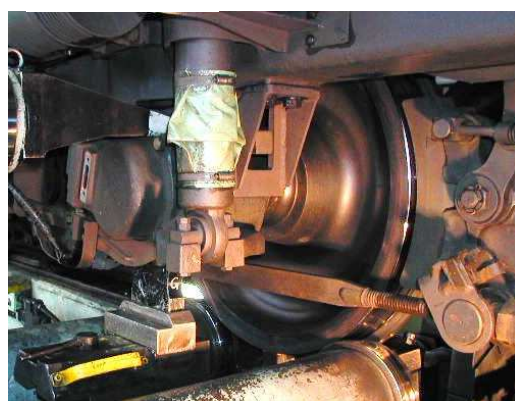
在姿車輪旋盤装置で車輪を削っている様子
