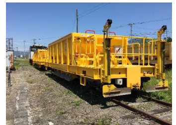
碎石散布用の保線作業用機械 (以下、「ミニホキ」)
