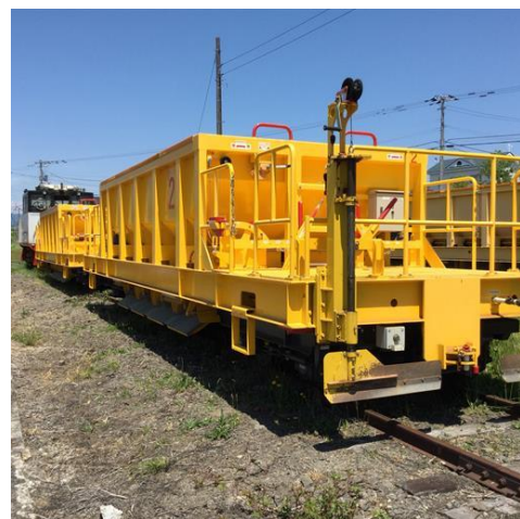
碎石散布用の保線作業用機械
