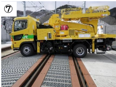
⑦ トンネル検査用軌陸車
