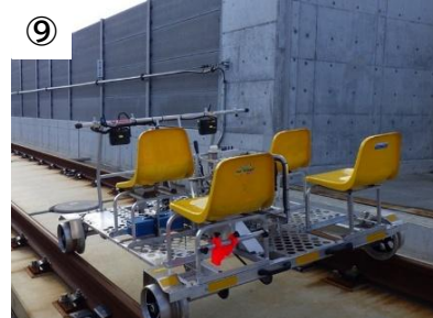
⑨ レールカート
