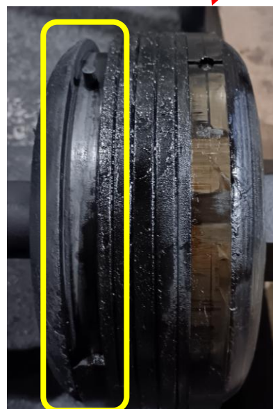
ピストンリング割損(黄枠部)
