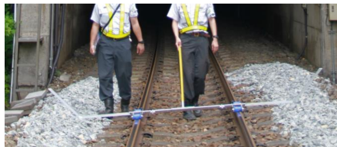
建築限界測定器組み立て後のイメージ （今回とは別箇所撮影）
