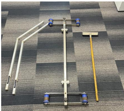
建築限界測定器外観
