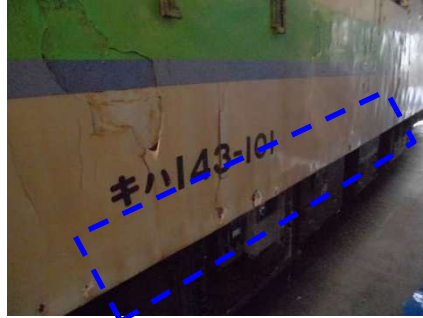
腐食大、穴あき
