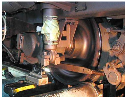
在姿車輪旋盤装置での車輪削正
