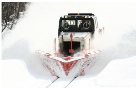
排雪モータカー等 先頭部にラッセル装置を取り付け、線路上の雪を脇へ押しのけます。 【配備数】新幹線 10 台 在来線 46 台 (うち、ラッセルモータカー 3 組)
