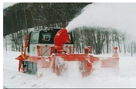
排雪モータカーロータリー等 ロータリー装置を取り付け、雪を遠くへ飛ばします。駅構内・駅間の双方に有効な除雪機械です。 【配備数】新幹線 8 台 在来線 71 台 (うち、ENR-1000 2 台)
