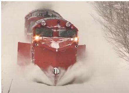
DE15 形ラッセル機関車 機関車の両先頭に除雪装置（前頭車）を連結しています。 【配備数】在来線 12 両
