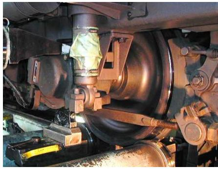
在姿車輪旋盤装置での車輪削正
