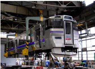
旅客車解艦装場で、20t クレーン 2 基を使って車両を吊り上げる迫力満点の作業をご覧ください。
