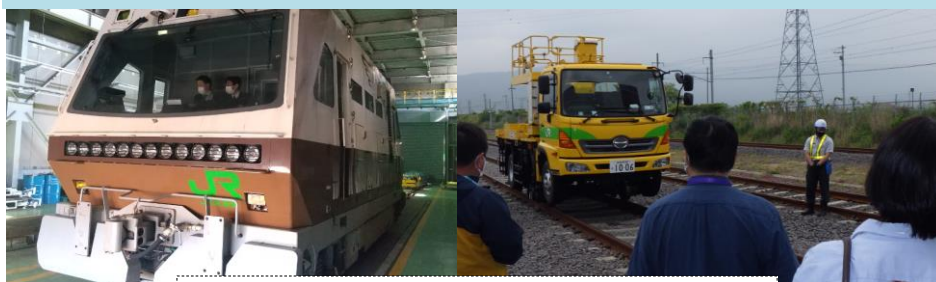
左:確認車/右:軌陸車(高所作業車)
