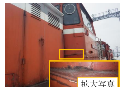
DE15 構体腐食状況
