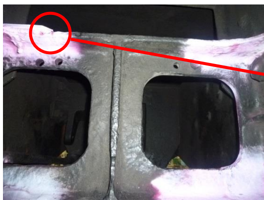
台枠の一部に発生したひびの修繕を実施（過去修繕時）
