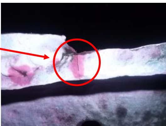
台枠の一部に発生したひびの修繕を実施（過去修繕時）
