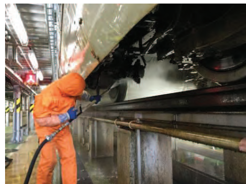
出発前(車両基地)の除去作業
