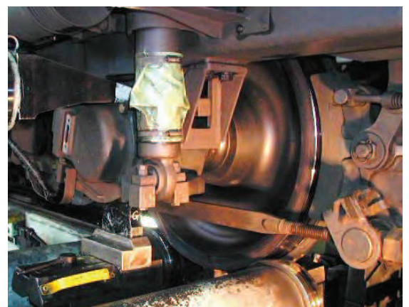
在姿車輪旋盤装置で車輪を削っている様子
