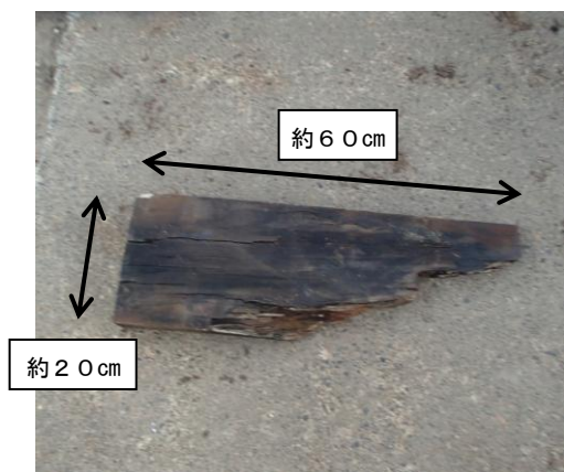
写真2 落下した木片
