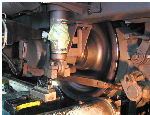
在姿車輪旋盤で車輪を削っている様子
