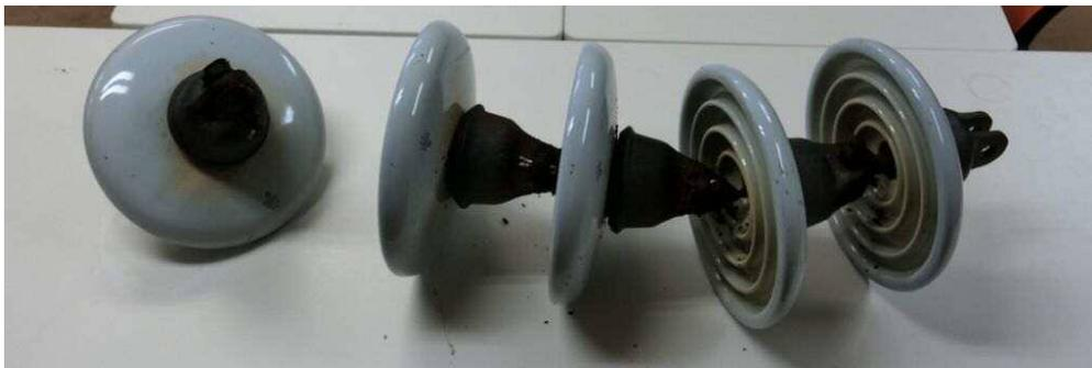
破損した碍子(種別 懸垂碍子 直径250mm×5個連)
