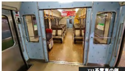
721系電車の例 客室内仕切り戸を開放し車内換気
