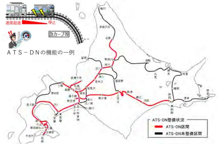
ATS-DN の整備箇所
