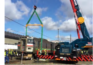
破損した車両をクレーンにて載線
