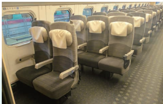
北海道新幹線 車いす対応座席(普通車指定席5号車に設置している。となりのスペースに車いすを折りたたんで置けるよう、ロープがついている。多目的トイレにも近く、乗降口も他の車両よりも広く取られている)。
