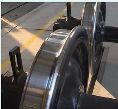
在姿車輪旋盤で削正した後の車輪。
