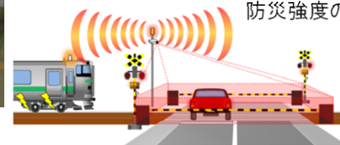
支障物検知装置を応用した衝突防止(イメージ)
