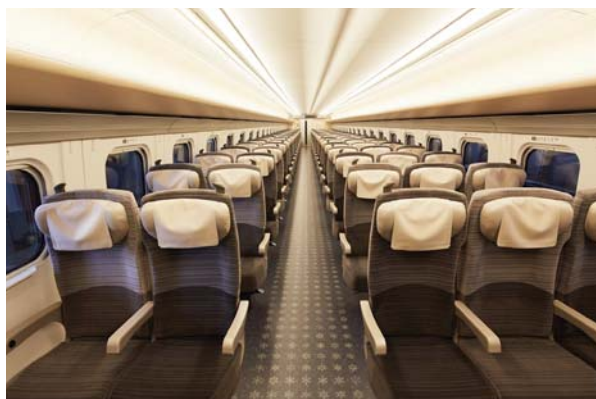
H5系車両の室内LED照明(普通車)
